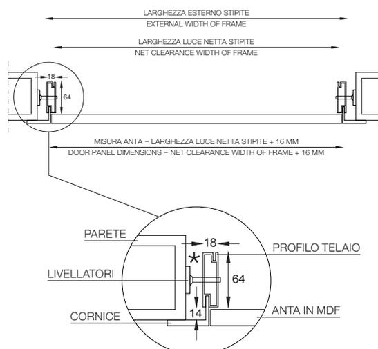
\* Area necessaria per inserire il telaio nella parete = 15 mm
